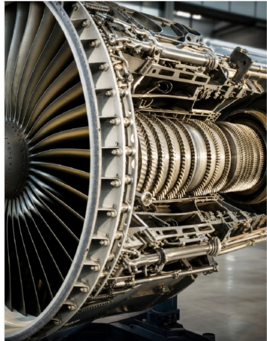
Coupe transversale de turbine de moteur à réaction — les superalliages de rhénium résistent aux températures extrêmes
