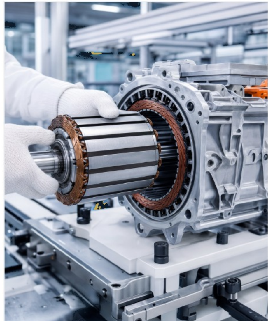
Assemblage de moteur de véhicule électrique — le dysprosium garantit que les aimants conservent leurs performances à haute température
